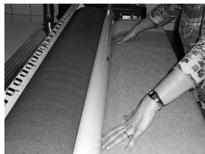
Figure 3: calandre avec un dispositif anti-coincement des doigts et des mains. La calandre s'arrête dès qu'on touche ce dispositif.
