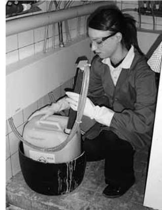
Figure 8: il faut porter des lunettes et des gants de protection lors de la manipulation de concentrés nettoyant.
