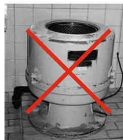
Figure 4: il ne faut pas utiliser d'essoreuses sans couvercle verrouillable.
