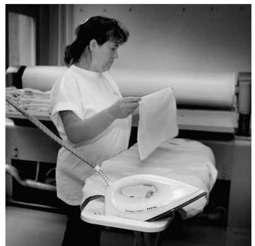
Figure 11: il faut un emplacement sûr pour déposer les fers à repasser non utilisés immédiatement. Dans une zone de passage, poser le fer sur la planche à repasser ne suffit pas pour garantir la sécurité.
