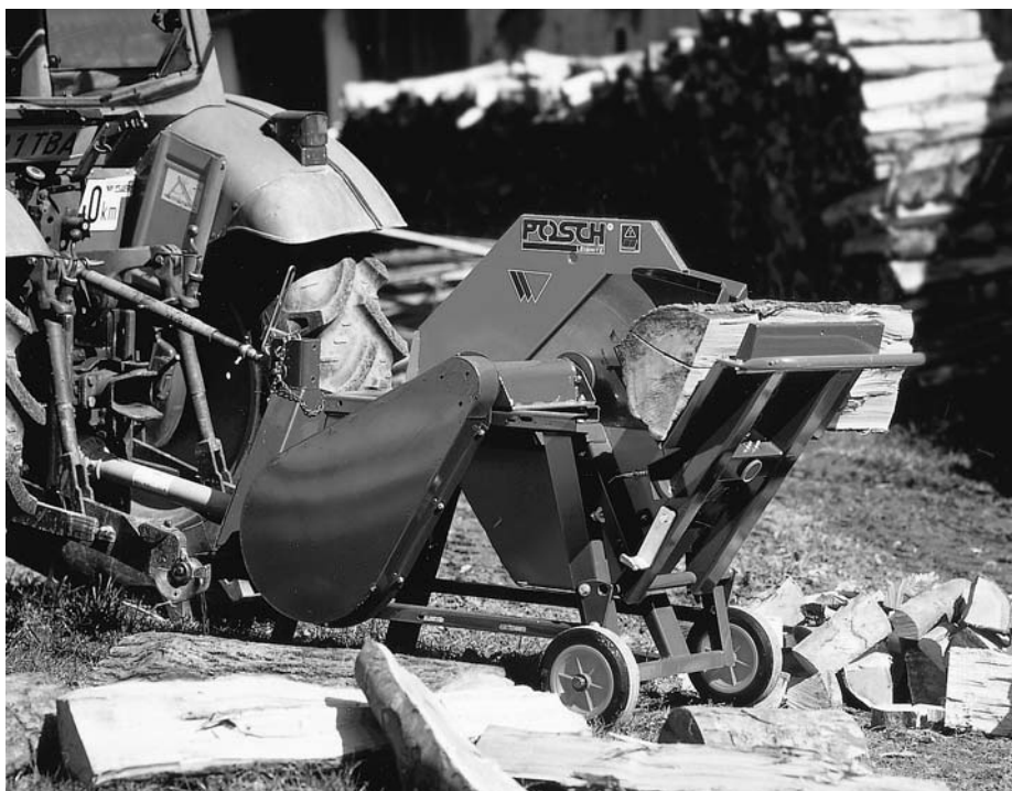
Figura 4 Trasmissione schermata di una sega circolare per legna da ardere.
