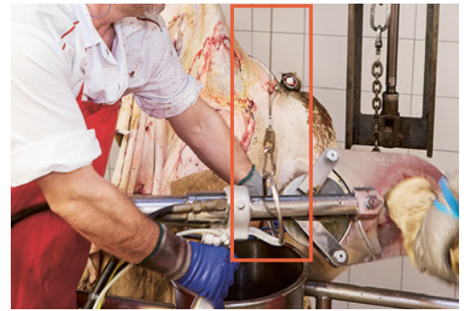
Bild 5: Gewichtsentlastende Aufhängung der Maschine
