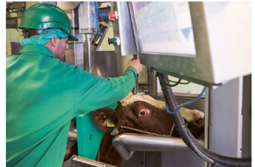
Bild 2: Geeignetes Fixieren des Tieres bei der Betäubung
