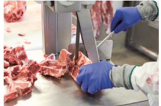
Bild 1: Korrektes Verwenden der Andrückvorrichtung
