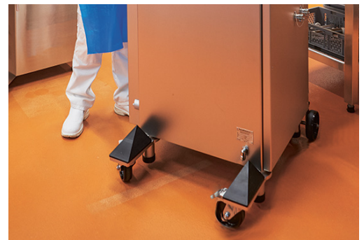
Bild 4: Gegen Wegrollen gesicherte Maschine
