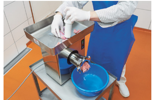
Figura 3: alimentazione manuale della carne con un pestello
