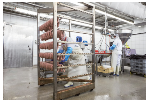
Figura 6: riempimento corretto del carrello
