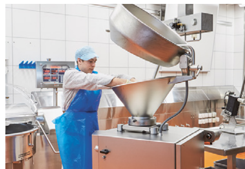
Figura 5: parte superiore della tramoggia ruotata verso l'alto per impedire l'avvio della macchina
