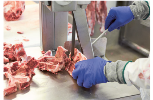
Figura 1: uso corretto del dispositivo di pressione
